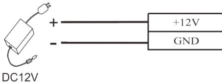
Input DC12V,  $\leq 110\text{mA}$  ( $\leq 80\text{mA}$  standby)
